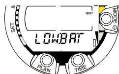
Abb. 3.2 Aktivierung II. Die Batteriespannung wird angezeigt.
