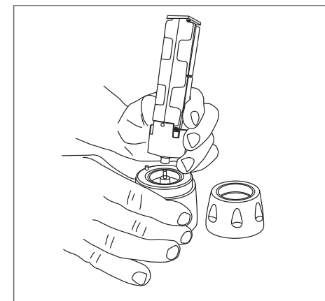
Dessin 8 - Mise en place correcte du compartiment piles
