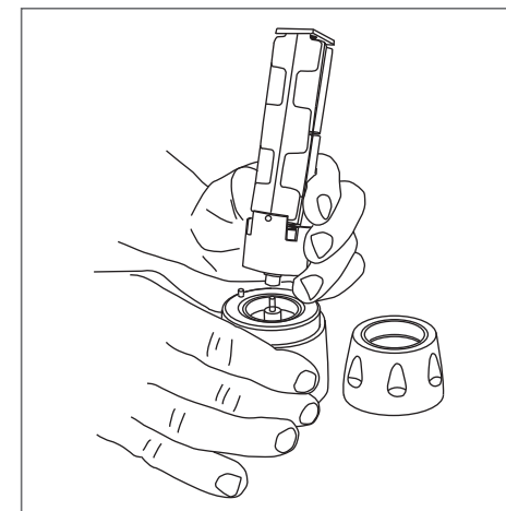
Fig. 8 - Corretto inserimento del cestello porta batterie
