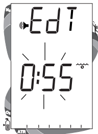
Abb. 22 - Einstellen des Alarms für verstrichene Tauchzeit
