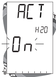
Abb. 42 - Einstellen der Aktivierung durch Wasserkontakt
