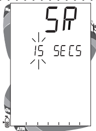
Abb. 40 - Einstellen des Speicherintervalls
