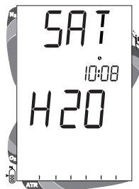
Abb. 82 - Entsättigungsmodus (Wasserkontakte nass)
