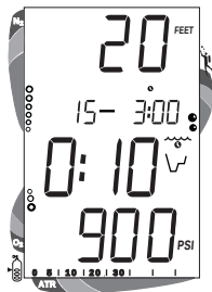
Abb. 54 - Anzeige Sicherheitsstop im Nullzeitmodus
