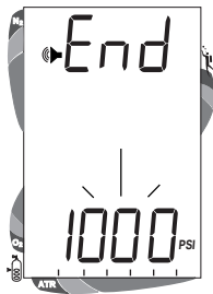
Abb.35 - Einstellen des Alarms für den Reserve-Flaschendruck
