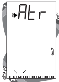
Abb. 33 - Einstellen des Alarms für die Restluftzeit
