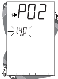
Abb. 37 - Alarm für maximalen O_2 -Partialdruck
