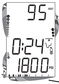
Abb. 48 - Balkenanzeige der Restluftzeit
