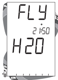
Abb. 81 - Flugmodus (Wasserkontakte nass)
