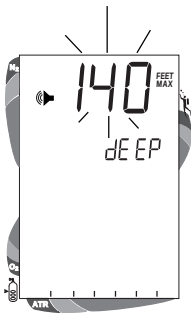
Abb. 21 - Einstellen des Alarms für maximale Tiefe
