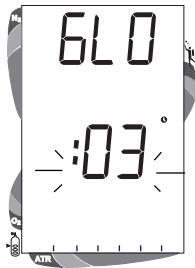
Abb. 39 - Einstellen der Dauer der Hintergrundbeleuchtung
