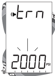
Abb. 34 - Einstellen des Alarms "Halber Flaschendruck/ Rückkehr zum Ausgangspunkt"
