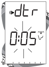
Abb. 36 - Einstellen des Alarms für verbleibende Tauchzeit
