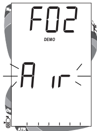
Abb. 88 - Einstellen des FO 2 (Simulation)
