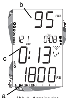
Abb. 6 - Anzeige des Flaschendrucks und Tiefenanzeigen
